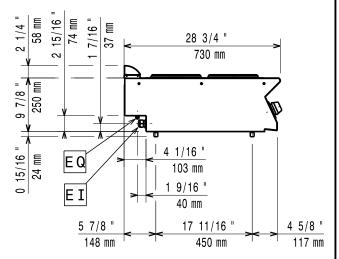
Electrical inlet (power) Equipotential screw
